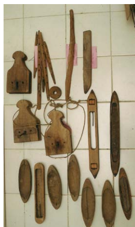
Telar horizontal del taller de Rafael Borrero, accionado por Gregoria Santos Donaire (1907-1989). Peine del taller de Manuela Carrero Malavé, Juego de lanzaderas (manuales y volantes), garruchas, espajillas y palos de urdir del taller de Rafael Borrero (Museo Casa Dirección)
