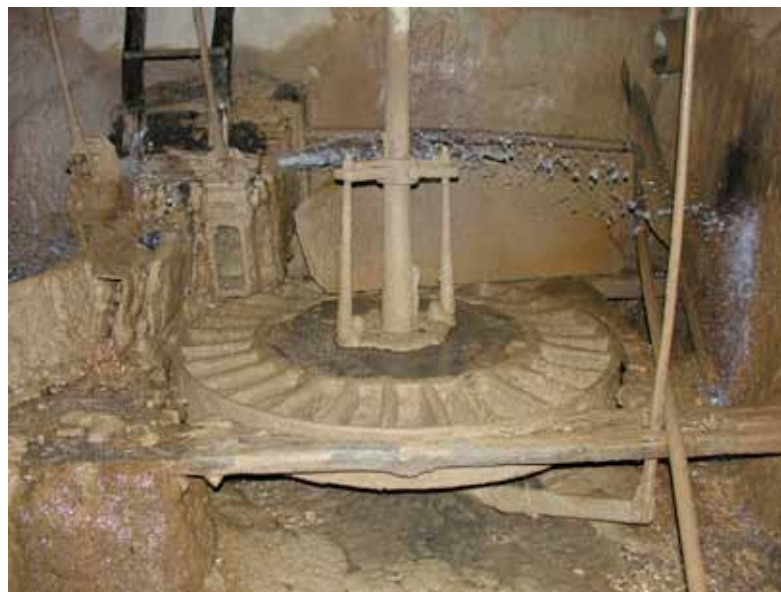
El Molino de los Juanetas, en Quintanarraya, pueblo perteneciente al municipio de Huerta del Rey: a la izquierda, interior de la sala de molienda con dos empiedros al completo y funcionando; a la derecha, interior del cárcavo con todos sus elementos (rodezo, saetín y alivio)
