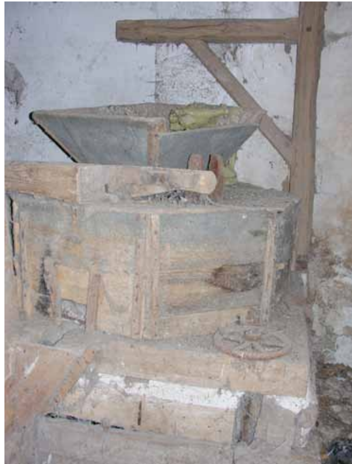
Molino del Monasterio de Santa María la Real, en Tórtoles de Esgueva: disponía de dos empiedros, el de la izquierda destinado a la molienda de granos para pienso y el de la derecha preparado para moler trigo
