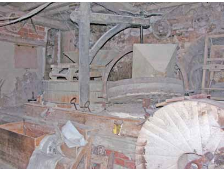
El Molino de los Juanetas, en Quintanarraya, pueblo perteneciente al municipio de Huerta del Rey: a la izquierda, interior de la sala de molienda con dos empiedros al completo y funcionando; a la derecha, interior del cárcavo con todos sus elementos (rodezo, saetín y alivio)
